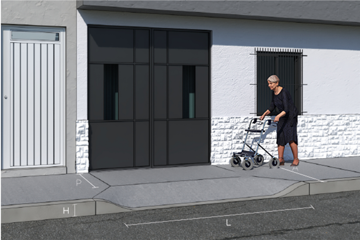
Adecuación de rampas vehiculares en banquetas con un ancho mayor a dos metros.
